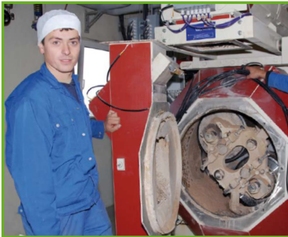
Beispiel Mühlenprodukt: In der Kieipresse zur Futterherstellung könnte es zu einem Kontakt zwischen Schmierfetten und Futterpellets kommen.
