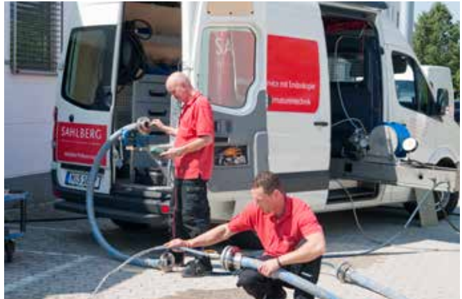
Schlauchwiederholprüfung mit Prüfmobil vor Ort
