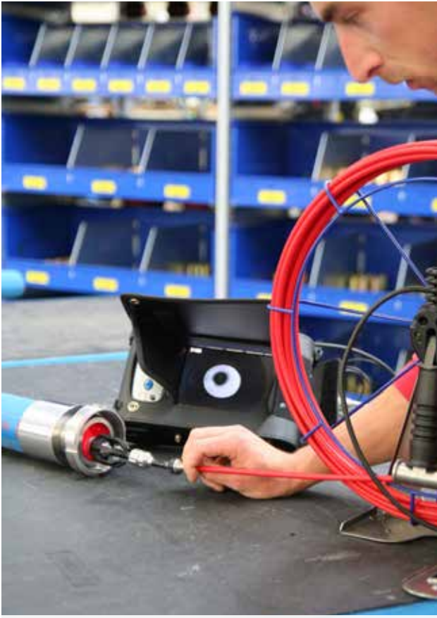
Endoskopie von Schlauchleitungen
