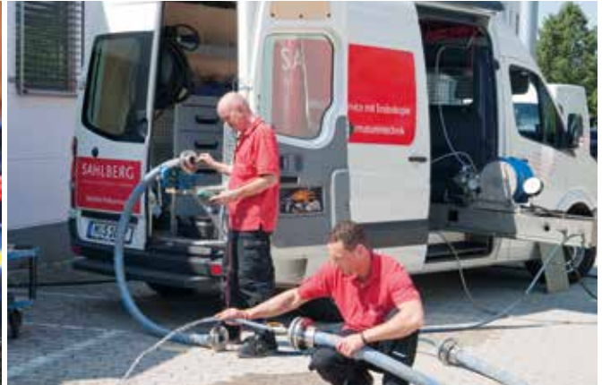
Schlauchwiederholprüfung mit Prüfmobil vor Ort
