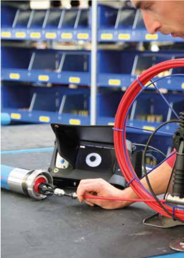
Endoskopie von Schlauchleitungen
